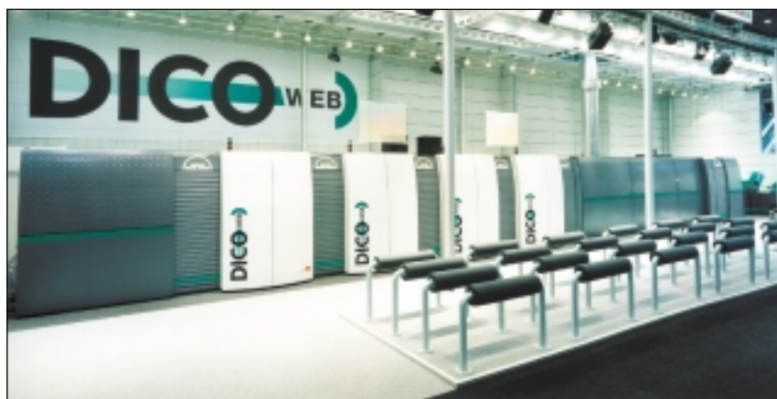
Zu den Computer-to-Press Verfahren zählt die Dicoweb-Technologie
