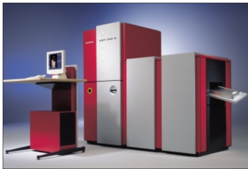
Die Xikon-Anlagen arbeiten elektrofotografisch und verwenden Trockentoner
