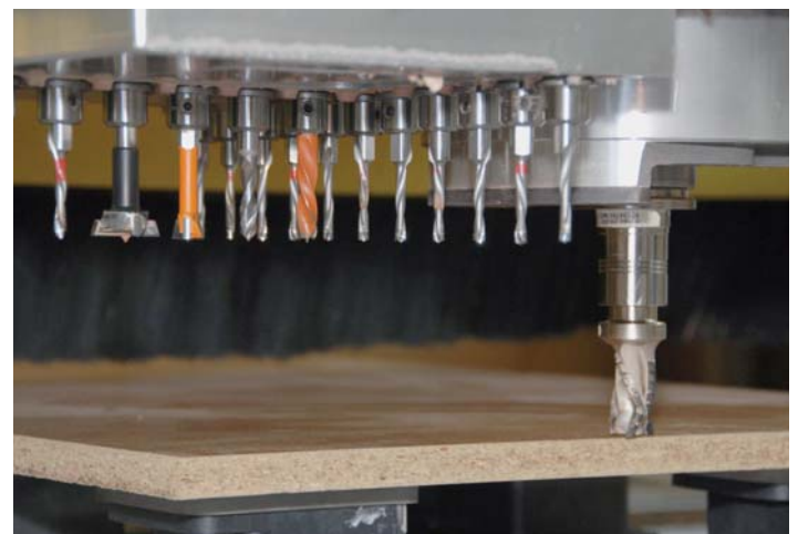
// BILD RECHTS: LEUCO BOHRER IM EINSATZ AUF EINER CNC-MASCHINE.
